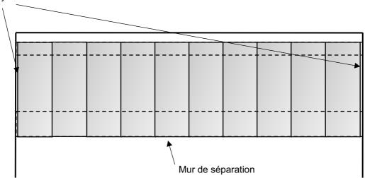
⚠ Le caillebotis ne doit pas dépasser à l'arrière de la poutrelle pour éviter d'endommager le volet.
