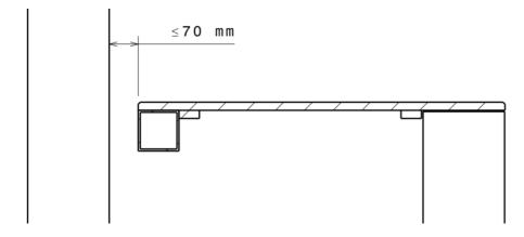
Le jeu entre le mur et les côtés des caillebotis doit être inférieur à 7 mm.
